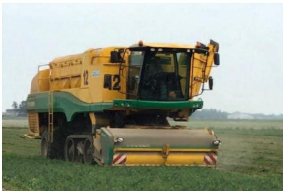
te da uno speciale film di nylon per eliminare possibili danneggiamenti del prodotto raccolto, esso friziona i baccelli in piccole porzioni contro la superficie del tamburo trebbiante. Il raccolto è quindi distribuito dal battitore principale e dal primo satellite del battitore nel secondo satellite del battitore e quindi convogliato alla parte
